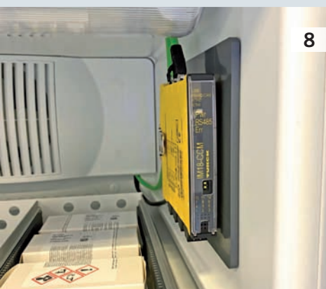
Obr. 1 IM18-CCM50 monitoruje teplotu a zatváranie dverí v každej zo štyroch chladničiek
