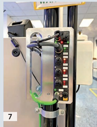
Obr. 5 Grafický prístrojový panel umožňuje na prvý pohľad vidieť stav chladničiek a ostatných pracovných staníc.
